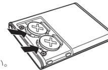
※交換するときは、電源オフの状態コイン電池を取り外し、新しいコイン電池をセットしてください。
